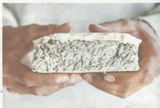
Ci-dessus: un échantillon de l'isolant chaux-chanvre que le propriétaire a pu coffrer lui-même.
